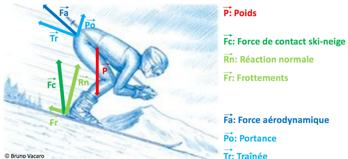
Figure 1.15 - Forces auxquelles le skieur est soumis lorsqu'il évolue selon une trajectoire rectiligne dans une pente
