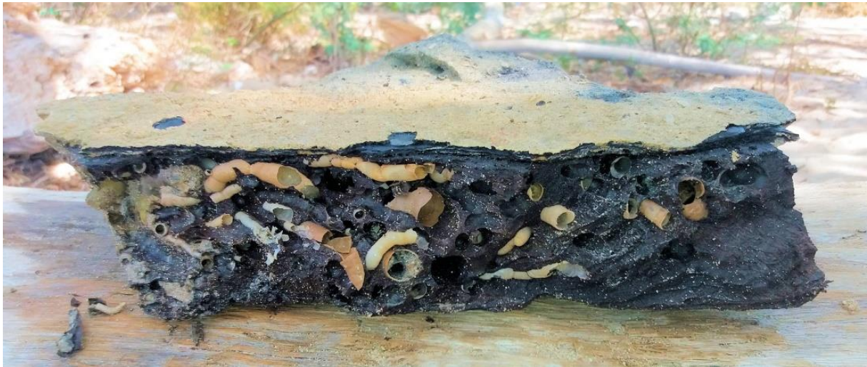
Fig. C2-023. Fine couche de cuivre et ravages du bois causés par les tarets. [ Copyright Admat 2018. ]
