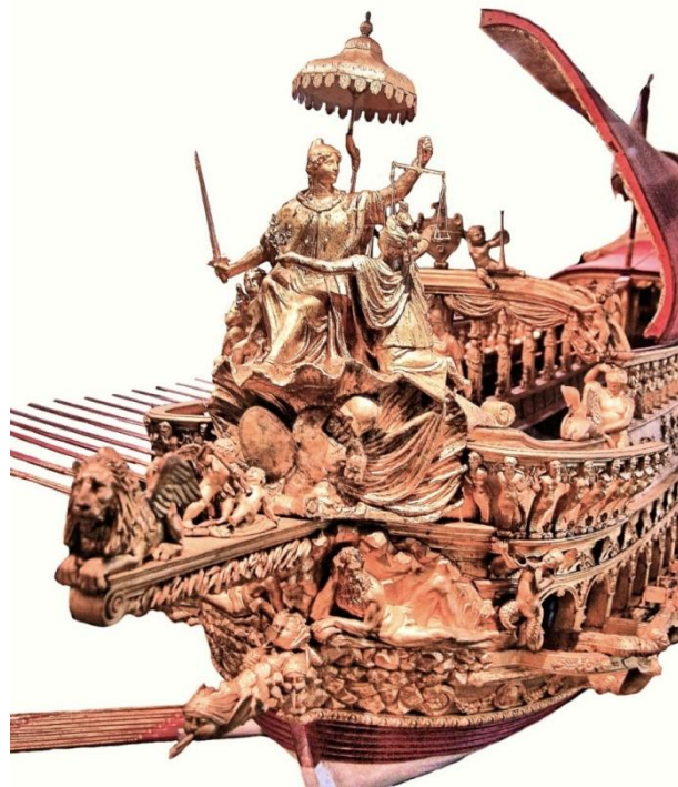
Fig. C3-019. Proue de la galère Bucintoro construite de 1772 à 1779 à Venise. [ D.R. Maquette du Musée de l'Arsenal à Venise. La galère réelle mesure 35 m de long et met en œuvre 168 rameurs sur 42 rames. ]
