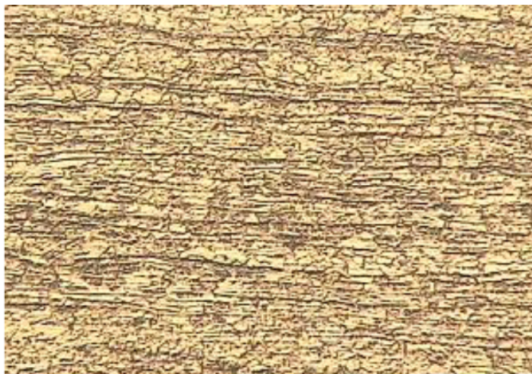
FIGURE 2.3 – Microstructure de l'acier laminé X-IP 1000 (Source : ArcelorMittal)
