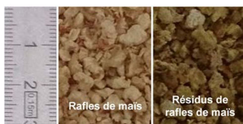
FIGURE 4.14 – Photographies des rafles de maïs avant et après l'extraction des solubles avec une solution de silicate de sodium à 5 %.
