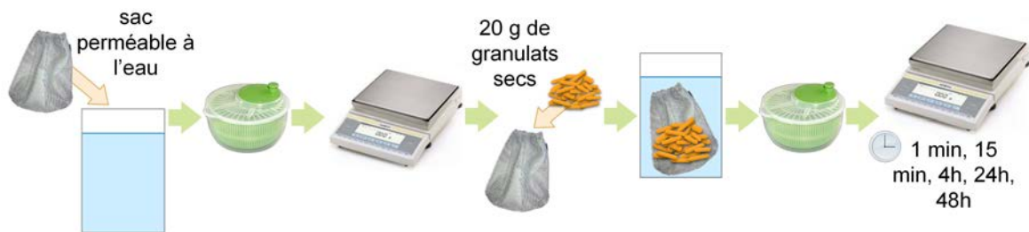
FIGURE 2.10 – Protocole de mesure de l'absorption d'eau.
