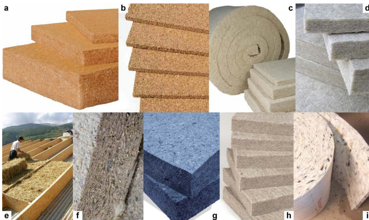
FIGURE 1.9 – Isolants naturels : (a) Panneaux de fibre de bois, (b) Panneaux de liège, (c) Panneaux et rouleau de laine de chanvre, (d) Panneaux de laine de lin, (e) Bottes de pailles, (f) Panneaux de ouate de cellulose issue du recyclage du papier, (g) Panneaux de ouate de cellulose issue du recyclage du tissu, (h) Panneaux de laine de mouton et (i) Rouleau de plumes de canard.
