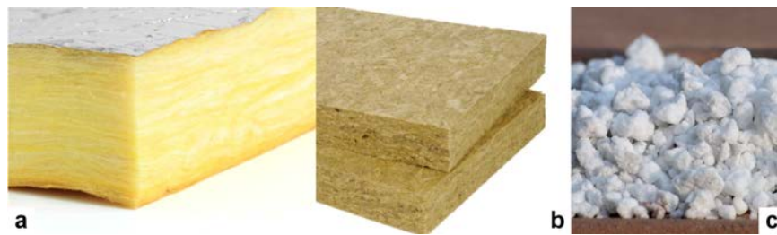
FIGURE 1.7 – Isolants minéraux : (a) Laine de verre, (b) Laine de roche et (c) Perlite.
