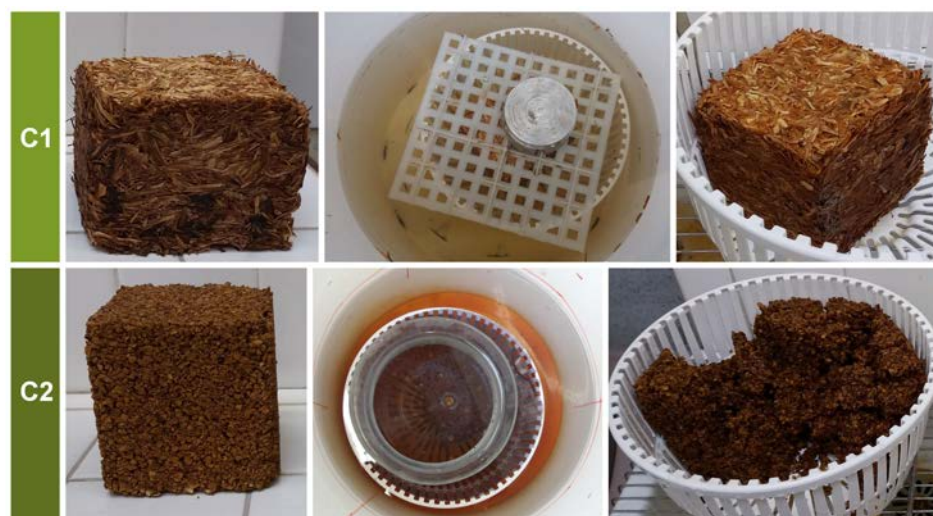
FIGURE 6.1 – Photographies des échantillons C1 et C2 avant, pendant et après le test d'immersion accidentelle (5 minutes dans l'eau).
