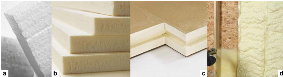
FIGURE 1.8 – Isolants synthétiques : (a) Polystyrène expansé (PSE), (b) Polystyrène extrudé (XPS), (c) Plaques de polyuréthane et (d) Polyuréthane projeté.
