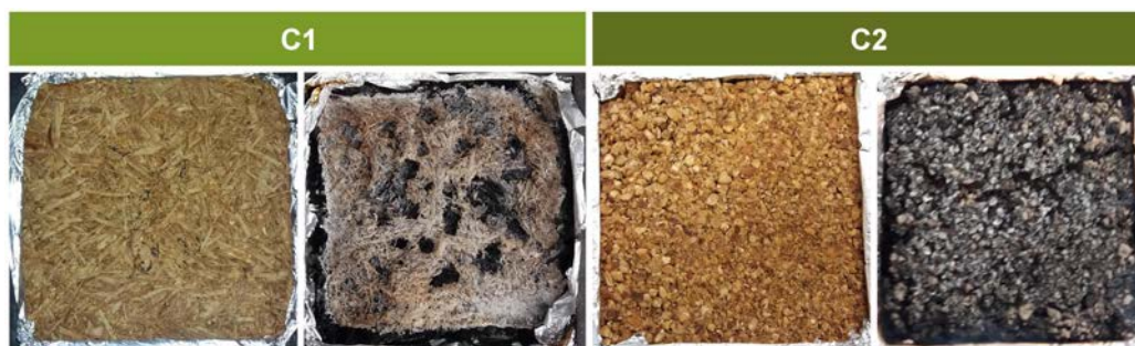
FIGURE 6.10 – Photographies des échantillons C1 et C2 avant et après le test au cône calorimètre.
