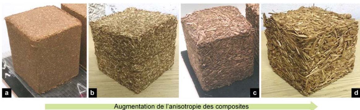
FIGURE 5.22 – Photos des composites (a) n°22, (b) n°13, (c) n°1 et (d) n°14, fabriqués avec différentes granulométries de particules de chanvre et de l'extrait de rafles de maïs.
