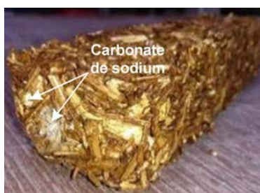
FIGURE 4.9 – Photographie de la surface d'un échantillon fabriqué avec des chènevottes et un liant issu d'une extraction entre la paille de blé et une solution de soude à 4 %, comportant des marques blanches dues à la réaction de carbonatation entre la soude et l'air.
