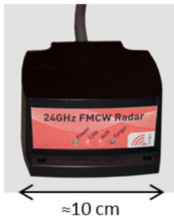
FIGURE 4.1.1 – Radar utilisé pour les expérimentations (IMST 24 GHz 2-Channel FMCW Radar). Source : www.imst.com .
