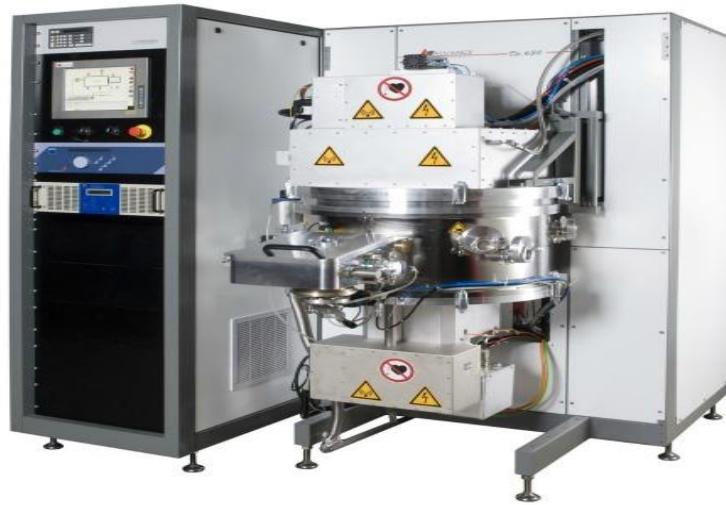
Figure 2. Bâti de pulvérisation cathodique en RF (Institut d'Electronique de Microélectronique et de Nanotechnologie, Université de Lille, France), Alliance Concept DP 650 N340
