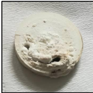
Figure III.38 : Photographie d'une cible fortement enrichie en alcalin après un dépôt par pulvérisation cathodique radiofréquence utilisant le magnétron
