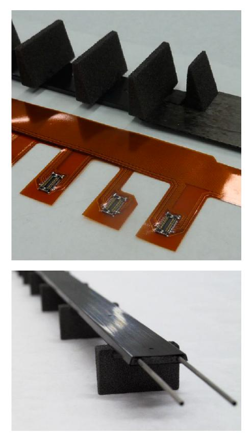
FIGURE 40 – Le détecteur alpin, de la conception à la réalisation : structure en mousse carbone incluant les tubes de refroidissement en titane, et services électriques sur circuits flexes équipés de connecteurs.
