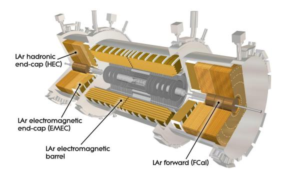
FIGURE 2 – Vue en coupe du calorimètre à argon liquide d'ATLAS.
