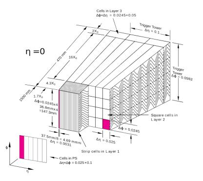
FIGURE 3 – Géométrie en accordéon des électrodes du calorimètre électromagnétique et segmentation longitudinale des cellules de lecture.
