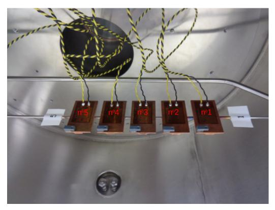
FIGURE 68 – Prototype thermique simplifié fabriqué par le CERN/Unige et installé pour des tests thermiques dans l'enceinte à vide du LAPP.
