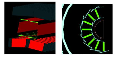
FIGURE 53 – Simulation Geant4 de la structure mécanique TRUSS supportant deux couches de modules pixels inclinés qui constitue la baseline du TDR pixel (gauche), et détails de la sructure mécanique IBeam (droite).
