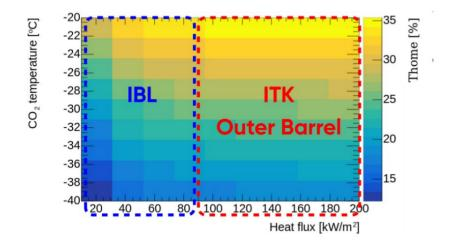
FIGURE 70 – Facteur de correction  $\alpha$  sur les prédictions HTC de CoBRA, extrait des ajustements contraints réalisés sur les mesures du prototype thermique simplifié. Dans la zone à très grand flux de chaleur, qui correspond à la région de fonctionnement du détecteur ITk, le modèle de Thome sousestime la valeur du coefficient de transfert thermique du CO2 de 30 à 35%.
