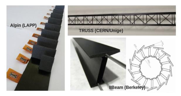
FIGURE 35 – Exemples de structures mécaniques en carbone proposées pour le détecteur à pixels ITk : Ibeam, Truss, et Alpin.
