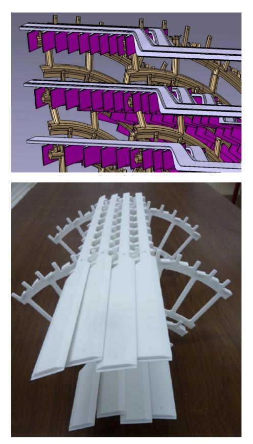
${\rm FIGURE}$  41 – Modèle CATIA des brides de support des échelles alpines et modèle d'intégration des échelles réalisé en impression 3D
