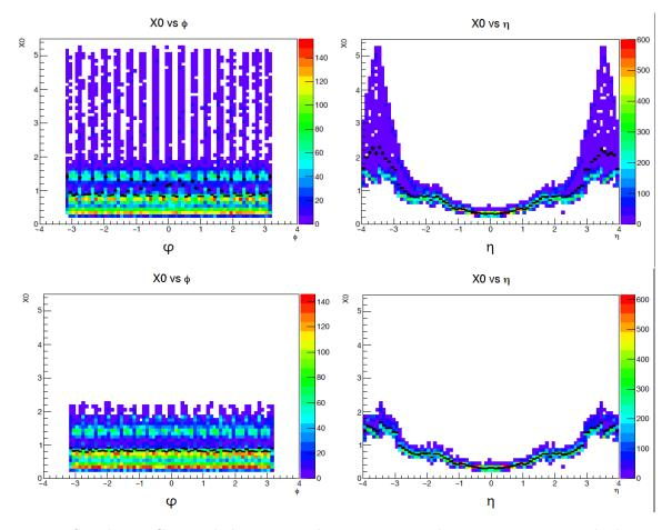
FIGURE 54 – Simulation Geant4 de la quantité de matière inerte liée aux services pour le détecteur à pixels ITk *Extended*, dans l'hypothèse de l'utilisation d'une structure de type IBeam et des câbles de type flexes (bas) ou twinaxes (haut) pour la transmission des données.
