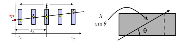
FIGURE 32 – Illustration des paramètres déterminant la précision sur la mesure de l'impulsion et du paramètre d'impact longitudinal des traces chargées dans le détecteur à pixels.
