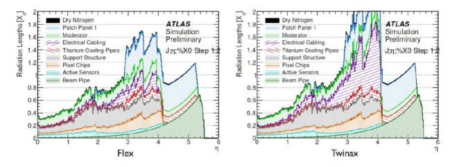
FIGURE 52 – Simulation Geant4 montrant la quantité de matière dans le détecteur à pixels ITk Inclined, dans l'hypothèse de l'utilisation de câbles de type flexes (gauche) ou twinaxes (droite) pour la transmission des données.
