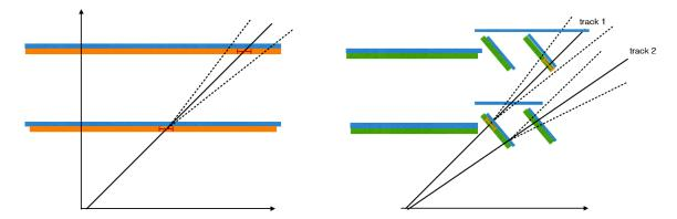
FIGURE 33 – Optimisation du détecteur à pixels basée sur l'utilisation de modules inclinés à la place d'un design classique de type tonneau/bouchon : réduction de la surface totale de silicium pour une même couverture angulaire, réduction de la distance d'extrapolation entre les points de mesures, multiples points de mesure par couche, réduction de la quantité de matière traversée grâce à l'angle d'incidence plus proche de la normale à la direction incidente des particules.
