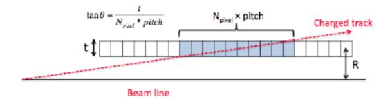
FIGURE 43 – Principe de fonctionnement du tracking *Extended* dans la région très à l'avant. L'angle d'incidence, reconstruit suffisamment précisément, pourrait permettre d'améliorer la résolution sur la position du vertex primaire et ainsi limiter l'effet du pile-up.
