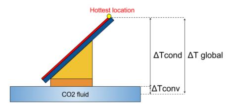
FIGURE 64 – Schéma descriptif des deux composantes influençant la température maximale à la surface du module : la composante convective ( $\Delta T_{conv}$ ) entre le fluide et la paroi du tube, déterminée à partir du logiciel CoBRA, et la composante conductive ( $\Delta T_{cond}$ ) entre la paroi du tube et la surface du module, simulée avec ABAQUS.
