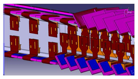
$\label{eq:FIGURE} FIGURE\,61-Design et routage des services électriques réalisés par le LAPP dans le cadre du programme démonstrateur Outer Barrel.$
