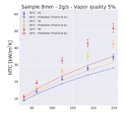
FIGURE 69 – Valeurs de HTC extraites des ajustements contraints réalisés sur les mesures du prototype thermique simplifié (markers), comparés avec les prédiction de CoBRA (lignes pointillées) en fonction de la densité de flux de chaleur  $\dot{q}$ . Les déviations s'observent pour les flux de chaleur importants, dans une zone de l'espace de phase ( $T_{CO_2}, \dot{q}$ ) très éloignée de celle des données qui ont été utilisées pour ajuster le modèle de Thome.
