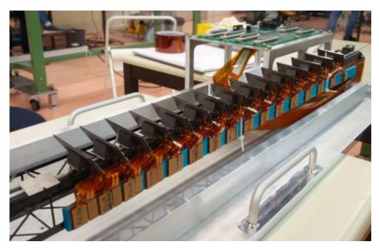
FIGURE 60 – Prototype thermique en cours d'assemblage, réalisé au CERN dans le cadre du programme démonstrateur *Outer Barrel*.
