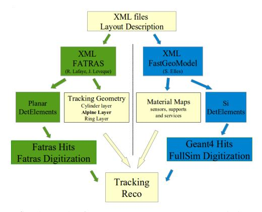
FIGURE 45 – Contributions du LAPP pour permettre une construction rapide de géométries ITk configurables via des fichiers XML.
