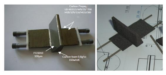
FIGURE 63 – Prototypes alpins fabriqués au LPSC et testés au LAPP pour l'évaluation des performances thermiques.
