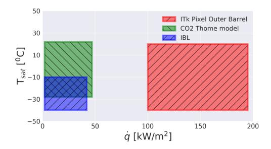
FIGURE 66 – Comparaison de l'espace de phase (Température du fluide  $T_{sat}$ ; Flux de chaleur  $\dot{q}$ ) correspondant aux données utilisées pour ajuster le modèle CoBRA (vert) avec les zones d'opération des détecteurs IBL (bleu) et ITk (rouge).
