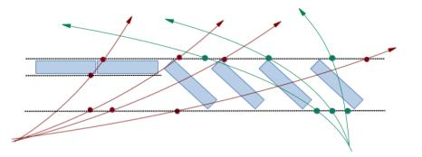
FIGURE 44 – Représentation schématique de la navigation dans une couche de pixels. Pour des modules horizontaux, le point d'entrée dans la couche de tracking est suffisamment proche du point de sortie pour permettre d'identifier de manière unique un module et son plus proche voisin. Dans le cas de modules inclinés, le nombre de surfaces actives touchées dépend de la distance parcourue et de l'angle de la trajectoire à l'entrée du volume de tracking.
