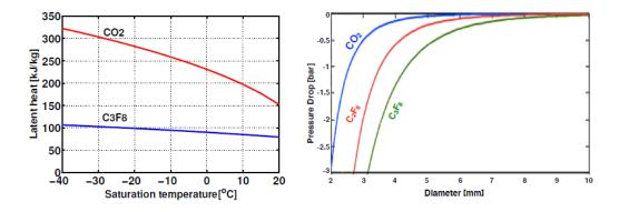
FIGURE 36 – Comparaison de la chaleur latente (gauche) et de la perte de pression le long du tube de refroidissement (droite) pour du CO2 diphasique, utilisés dans IBL, et le C3F8, utilisé dans les pixels d'ATLAS.
