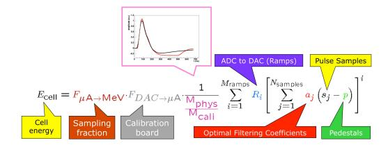
FIGURE 4 – Reconstruction de l'énergie des cellules du calorimètre à partir de la méthode des coefficients d'*Optimal Filtering* [ref3].
