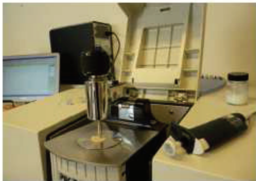
Figure 5. Spectromètre infrarouge avec dispositif de réflexion totale atténuée (ATR) et explant de peau de porc (A). Spectre ATR-FTIR transformé de Fourier.
