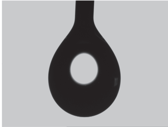
Figure 45. Image numérique pour la mesure de la tension superficielle d'une huile.
