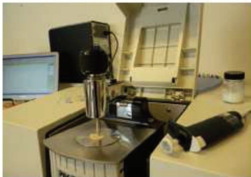
Figure 5. Spectromètre infrarouge avec dispositif de réflexion totale atténuée (ATR) et explant de peau de porc (A). Spectre ATR-FTIR transformé de Fourier. Infrared spectrometer with attenuated total reflectance (ATR) and pig side skin explant. ATR-FTIR spectrum Fourier transformed.
