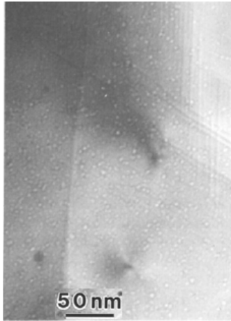
Figure 6 – Image MET d'une lame mince d' UO_2 irradié à 23 GWj/t_U [37]
