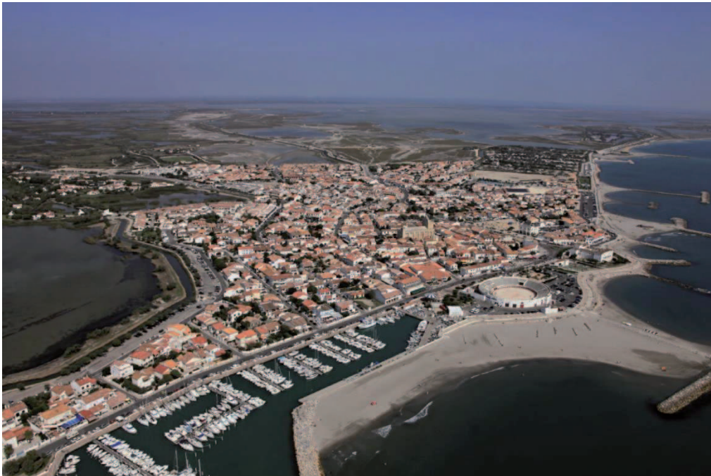
Figure 1.7 : Vue aérienne oblique vers l'est du « village » des Saintes-Maries-de-la-Mer. Celui-ci est bordé par la « digue à la mer » dont une partie est confortée par des épis et des brises-lames visant à atténuer l'effet mécanique des vagues. Les marais et étangs entourent le « village » et s'étendent à perte de vue. Source : DDTM 13, 2017.
