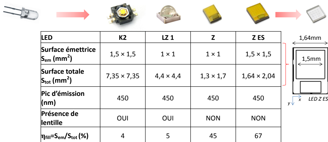
FIGURE 1.10 – Comparatif entre les packaging de différents modèles de LED disponibles en 2014. A titre d'exemples sont aussi présentés à gauche la photo d'une LED à broches (première génération de LED) et à droite une LED Luxeon Flipchip aujourd'hui disponible sur le marché.
