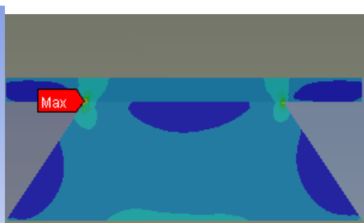
Figure III-17 Déformation totale sur le via à +80°C et -40°C en linéaire et en non-linéaire au 25 ème cycle
