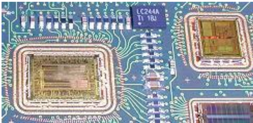
Figure I-15 Exemple de puce nue montée (CoB) [Ees]
