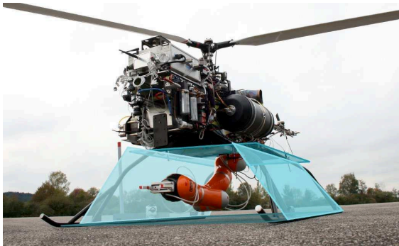
(a) Hélicoptère associé à un bras Kuka à 7 degrés de liberté [Huber et al., 2013].
