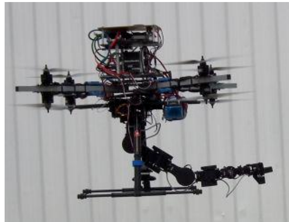
(b) Quadricoptère associé à un manipulateur à 7 degrés de liberté [Heredia et al., 2014].
