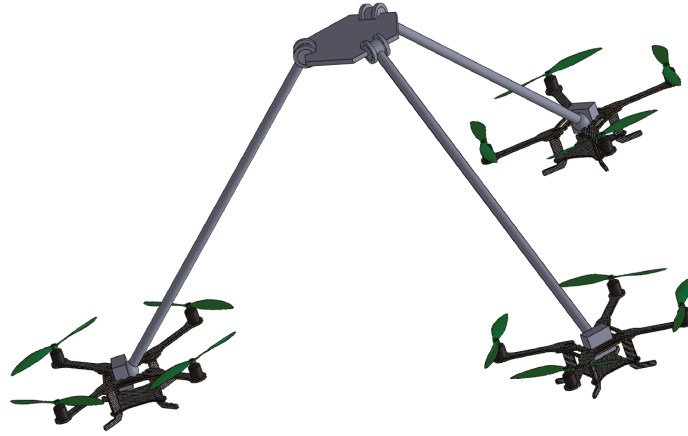
FIGURE 3.1 – Vue CAO du robot parallèle volant à trois drones.
