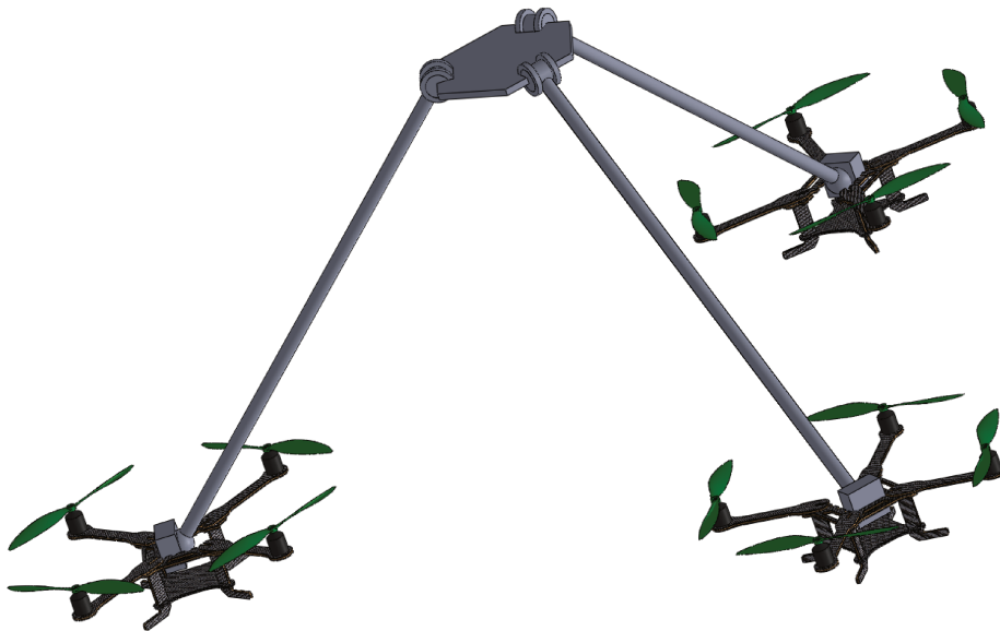
FIGURE 2.2 – Exemple de robot parallèle volant à trois drones.
