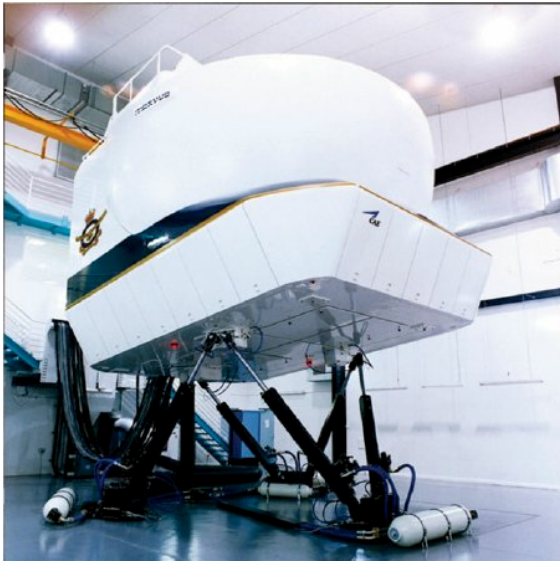
(a) Hexapode (6 – UPS ) utilisé pour la simulation de vol (CAE).
