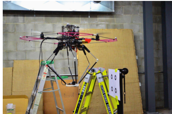
(d) Quadricoptère associé à un robot parallèle [Danko et al., 2015].
