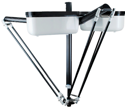
(a) Robot Delta ( 3 - \underline{RRPaR} ) par OMRON
