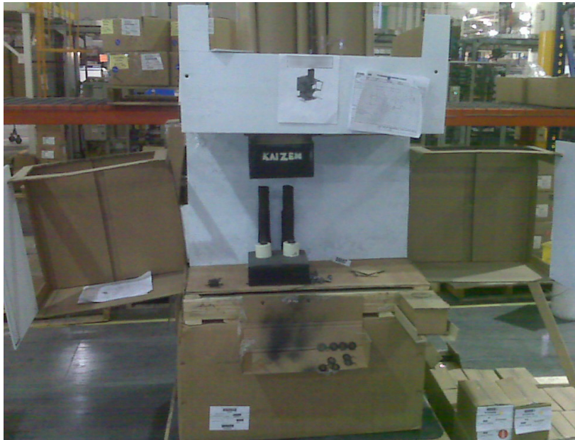
Fig. 1.5 Maquette-carton à l'échelle 1 d'un futur poste de travail
