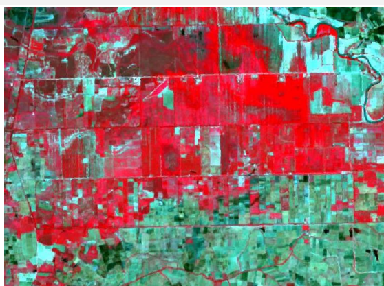
Image landsat-8 avant le pansharpening Composition colorée RVB (R=Band 5 ; V= Band 4 ; B= Band 3)
