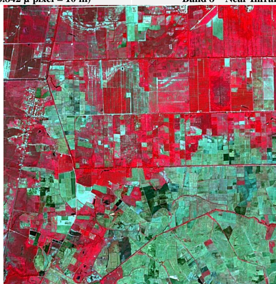
Image Sentinel-2 après le pansharpening: Composition colorée RVB (R=Band 8 ; V= Band 4 ; B= Band 3)
