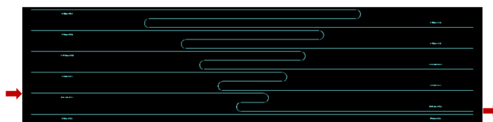
FIGURE 3.24 – Représentation des guides d'onde en "S" de différentes longueurs.
