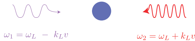
FIG. I.8 – Fréquences perçues par l'atome éclairé par deux faisceaux contrapropageants, pour un atome se déplaçant de gauche à droite.
