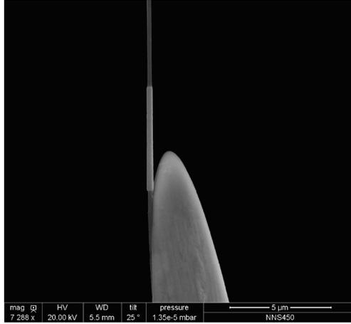
**Figure 3.5** – Image MEB de l'échantillon après un dépôt de platine. La longueur mesurée du dépôt est de  $5,122\mu m$ .
