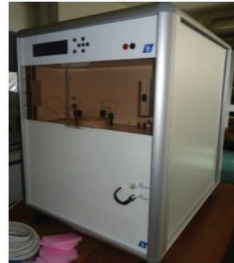
Figure 55 : Schéma de principe et photographie de l'hystérésigraphe utilisée pour les mesures de cycles d'hysteresis
