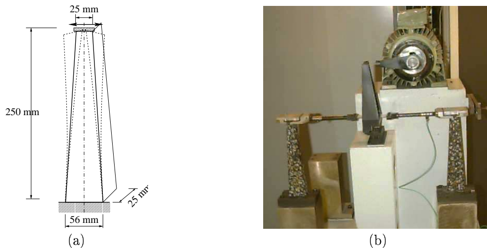
FIG. 1.5 : Essais de flexion sur éprouvette trapézoïdale NF P 98 260 1 : (a) géométrie de l'éprouvette - (b) dispositif expérimental
