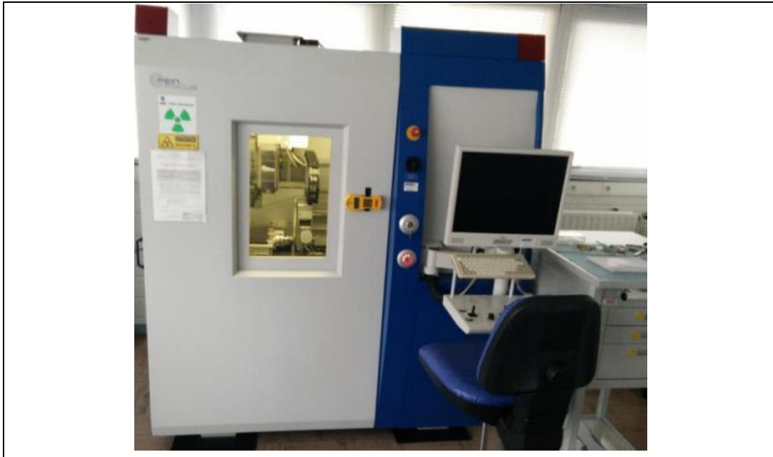
Figure 2.11 : Machine de radiographie FeinFocus FOX-160.25.
