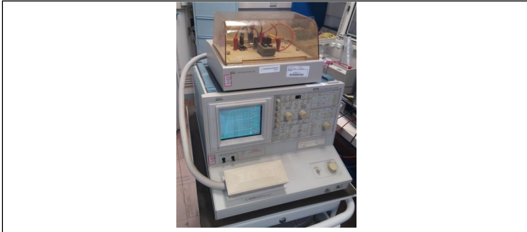
Figure 2.28 : Traceur de courbe de puissance Tektronix 371A.
