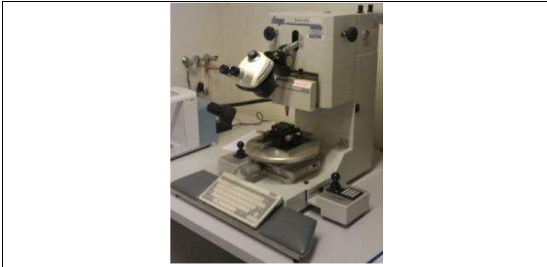
Figure 2.19 : Machine de cisaillement Dage série 4000.
