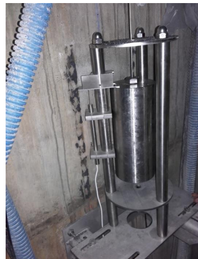
Figure 26. Schéma de principe et vue sur site d'un fil Invar (© EDF).
