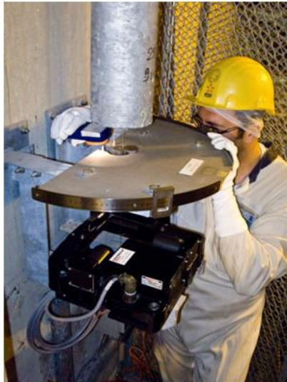
Figure 25. Lecture manuelle sur un pendule. On distingue la table à pointes de visée ainsi que le télépendule optique situé en dessous (© EDF).
