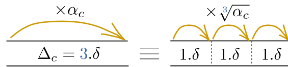
FIGURE 7.2 – Discrétisation aux compartiments. Le compartiment c = (\alpha_c, \Delta_c) est découpé en sous-compartiments de manière à préserver le temps de traversée et l'atténuation globale à l'issue de c .
