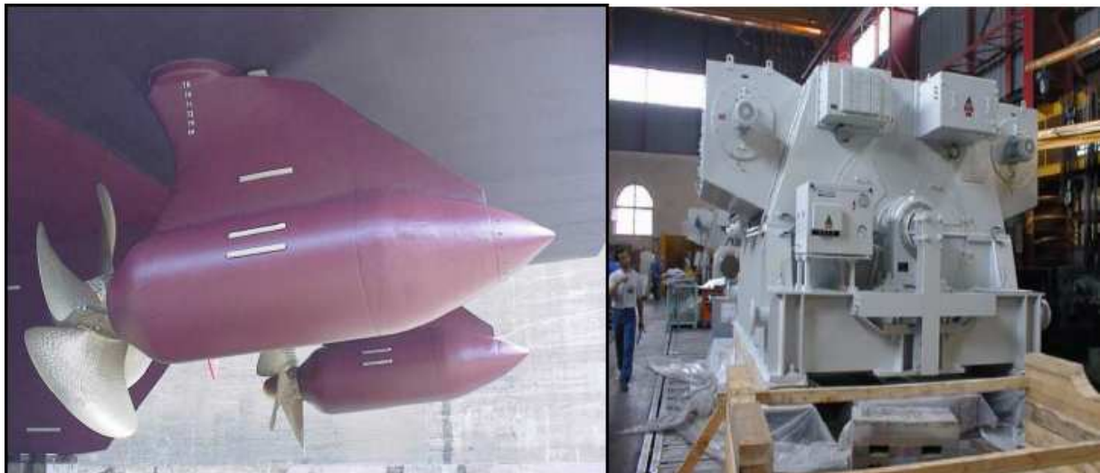
Figure 42. A gauche moteur POD (hors bord) et à droite moteur « in-board »
