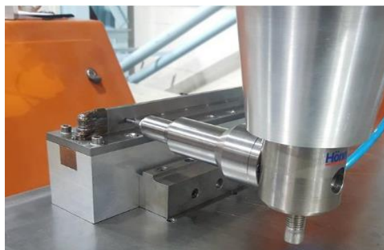
Figure 20 : Système de martelage [45]
