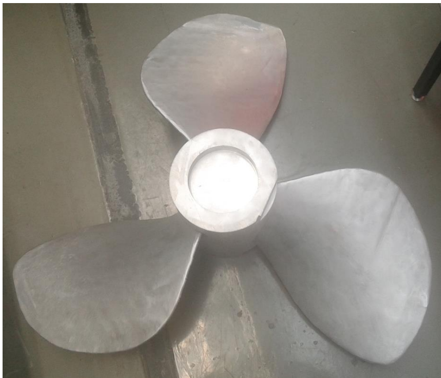
Figure 54 : Hélice après opération de parachèvement
