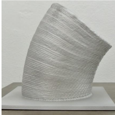
Figure 65 : Coude fabriqué avec une vitesse d'avance variable (variation continue de l'épaisseur de couche)
