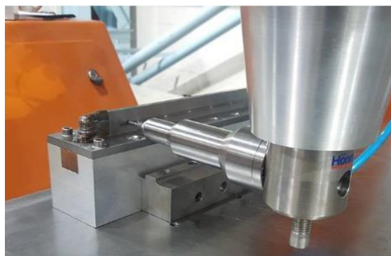
Figure 20 : Système de martelage [45]
