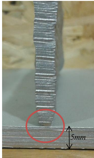
Figure 74 : Fabrication d'un mur à paramètres opératoires constants Paramètres : TS = 800 mm/min WFS = 7 m/min LH = 1.9 mm, AlMg5 – 5356 Ø1.2 mm, I = 96 A, U = 9.8 V.
