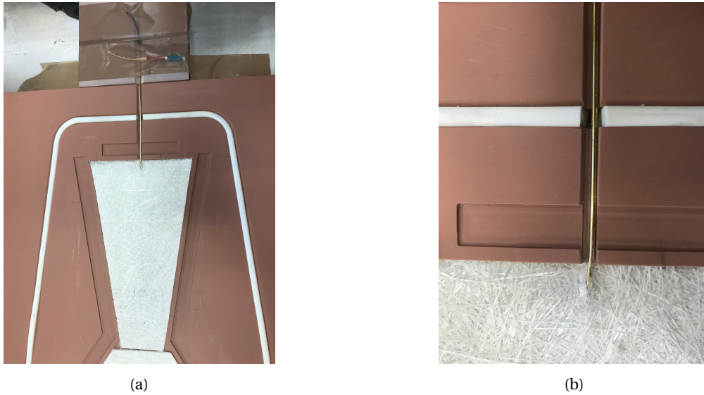
FIGURE II.11 – (a) Mise en place dans le demi-moule intrados du demi-profil drapé et recouvert de mat, (b) Détail de l'arrangement du demi-moule intrados pour laisser passer les connecteurs de la fibre optique placée dans le matériau.
