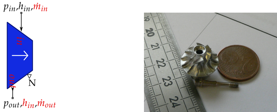
FIGURE 2.15 – Sur la gauche, une vue Simcryogenics de la turbine avec un port de sortie permettant de visualiser la vitesse de rotation nommée N . Sur la droite, une photo de la roue d'une turbine cryogénique.
