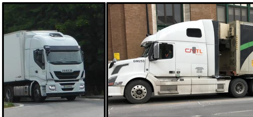
Figure 11.3 : Comparatif des cabines européenne et canadienne
