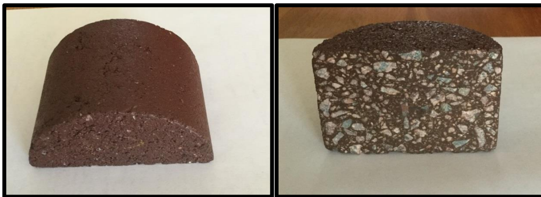
Figure 6.13 : Coupe de l'enrobé utilisé Photographies : Michèle St-Jacques
