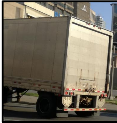
Figure 11.13 : Protection contre l'encastrement située à l'arrière d'un camion (Montréal, Québec)
