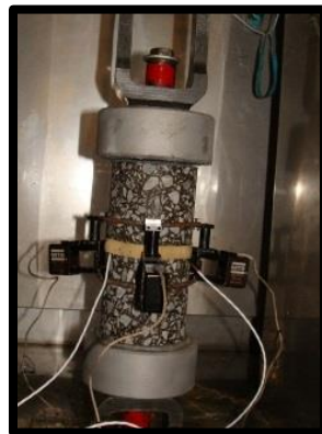
Figure 8.3 : Essai de module complexe Photographie : Michèle St-Jacques
