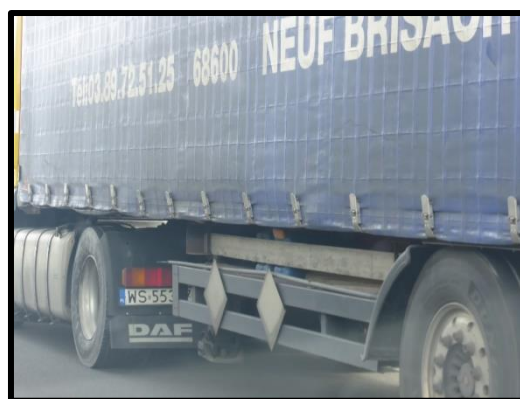
Figure 11.10 : Barre de protection latérale rigide sous un camion
