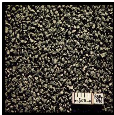
Figure 7.2 : Enrobé drainant Photographie : Yves Brosseaud
