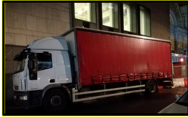
Figure 11.11 : Camion équipé de protections latérales (Londres, Angleterre)
