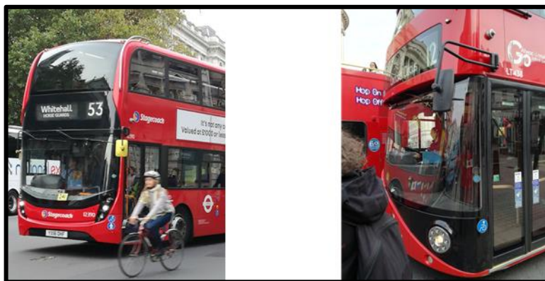
Figure 11.14 : Autobus appliquant le principe de « Direct Vision » (Londres, Angleterre)
