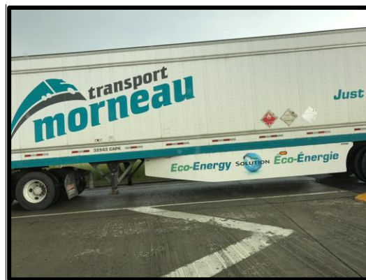
Figure 11.12 : Camion équipé d'un dispositif aérodynamique (Saint-Sauveur-des-Monts, Québec)
