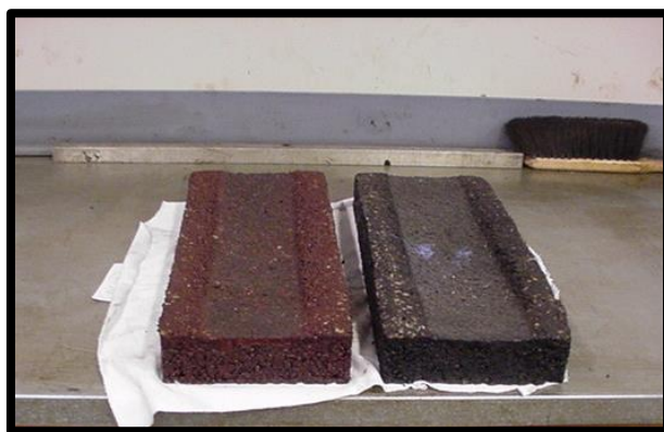
Figure 6.24 : Ornières sur revêtement bitumineux coloré vs noir
