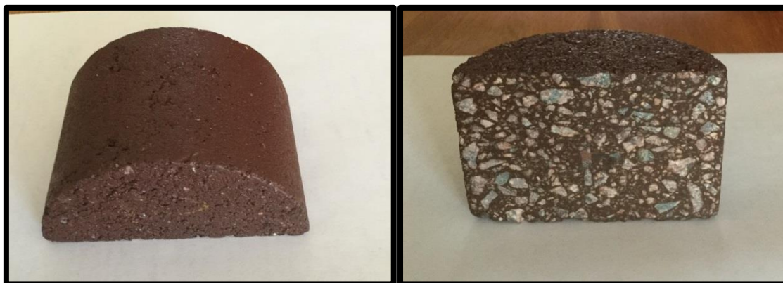
Figure 6.13 : Coupe de l'enrobé utilisé Photographies : Michèle St-Jacques
