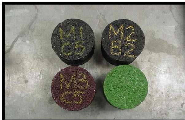
Figure 6.12 : Briquettes des 4 mélanges d'enrobés colorés Photographie : Michèle St-Jacques
