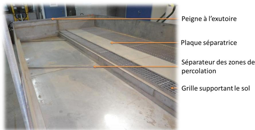
*Figure 3-1 : Infrastructure du dispositif expérimental à vide*
