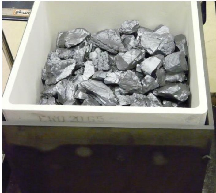
Figure 2. 1. Photo du creuset en silice contenant la charge de silicium et le contre creuset en graphite (lingot GAIA 89)
