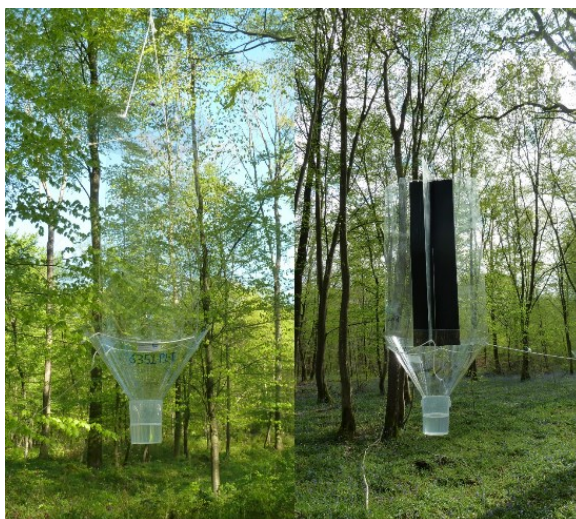
Figure 14. Photographie des deux types de piège à interception passif (Polytrap) des coléoptères saproxyliques installés en forêt de Compiègne
