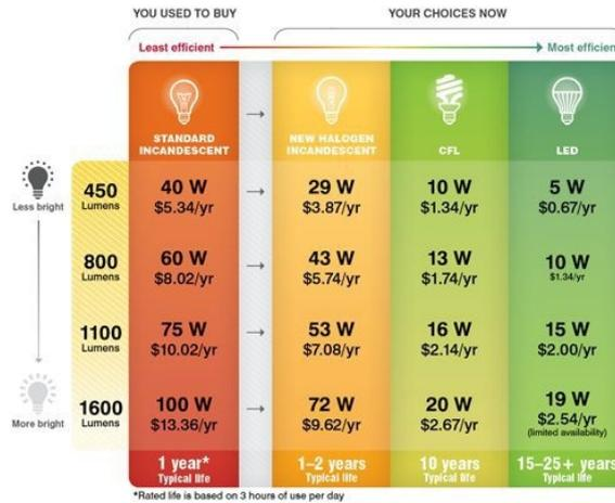
FIGURE 2.8 – Comparatif des différents types d’ampoules [13]
