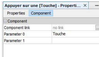
Figure 92. Panneau de propriété d'une tâche "composant"
