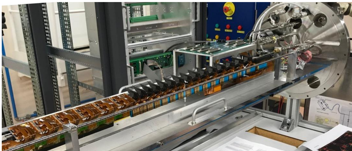
Figure 2 – Photographie du démonstrateur thermique en longueur réelle avec les modules de chauffage thermique assemblés au cluster de Paris et installés sur la section inclinée.
