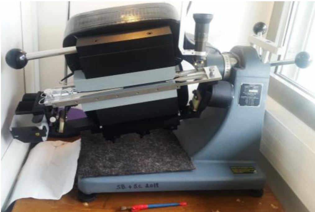
Figure 3: Séparateur magnétique (Frantz) (Laboratoire Géosciences et Environnement Toulouse, GET).
