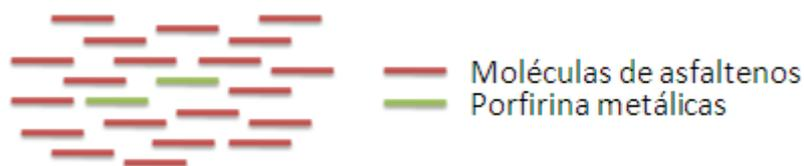
**Figura 58. Modelo de las porfirinas metálicas ocluidas por el agregado de asfalto**
