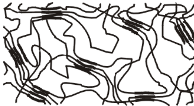
Figure 31. Morphologie du polyuréthane: segments mous (traits fins) et segments durs (traits épais)
