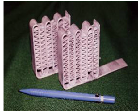
FIGURE 2.9 – Détails de la structure « Heat Lane » développée par Akachi et al. [18]
