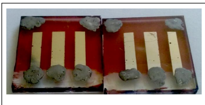
Figure 4.79 : Photos des cellules FTO/WO 3 /SAM/P3HT-PCBM/ZnO/Al après vieillissement : à gauche : CH 3 O-A : à droite F-A
