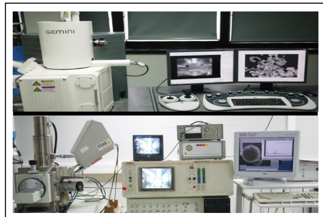
Figure 2.33 : Montage : MEB Jeol à canon thermoélectronique, équipé d'un spectromètre EDX et un MEB-FEG Zeiss (Zeiss SUPRA 40) équipé d'un dispositif de lithographie.
