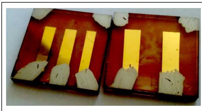
Figure 4.78 : Photos des cellules FTO/ZnO/SAM/P3HT-PCBM/PEDOT-PSS/Au après vieillissement : à gauche : CH 3 O-A : à droite F-A
