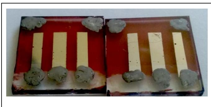
*Figure 4.79 : Photos des cellules FTO/WO<sub>3</sub>/SAM/P3HT-PCBM/ZnO/Al après vieillissement : à gauche : CH<sub>3</sub>O-A : à droite F-A*
