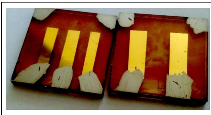
*Figure 4.78 : Photos des cellules FTO/ZnO/SAM/P3HT-PCBM/PEDOT-PSS/Au après vieillissement : à gauche : CH<sub>3</sub>O-A : à droite F-A*
