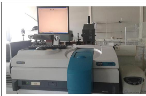
*Figure 2.31 : Spectromètre Varian Cary 500*
