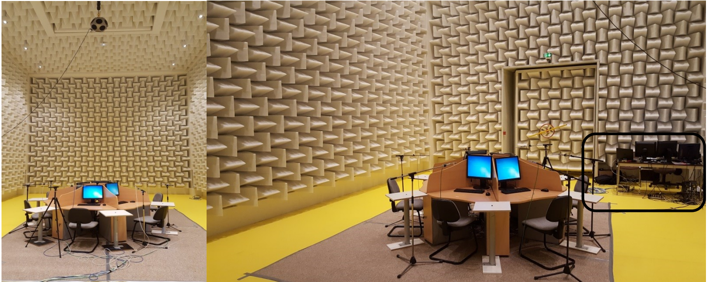
Figure 4.1. Banc expérimental (à gauche, vue sur la marguerite depuis l'entrée de la salle semi-anéchoïque. A droite, vue sur l'entrée et le poste de l'expérimentateur : partie entourée sur la droite de la photo)
