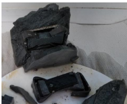
Figure 91 – Bloc de MCB contenant 2 échantillons en acier API5L X65 après 8000 heures d'exposition à 90°C dans la solution 12 aérée
