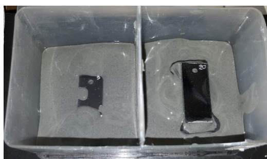
Figure 90 – Enrobage de coupons en acier API5L X65 avec du matériau ciment-bentonitique
