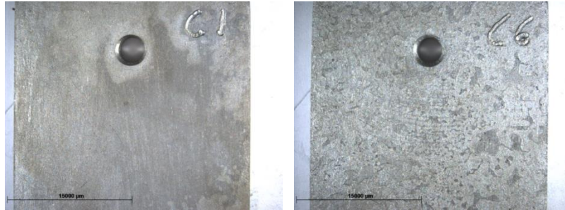
Figure 30 - Coupons en acier X65 immergés pendant 8000 heures (à gauche dans la solution, à droite dans l'argile)
