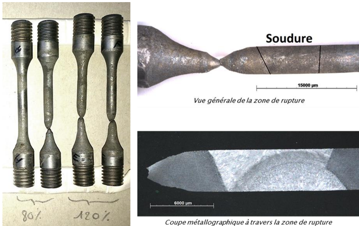
Figure 42 – Eprouvette lisses en acier X65 (soudure longitudinale) chargées à 80% et 120% de la limite d'élasticité, immergées dans l'argile et détails à droite de la rupture à 80% de R_{p0,2}
