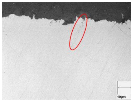
Figure 33 - Eprouvette métal de base P265, coupe longitudinale
