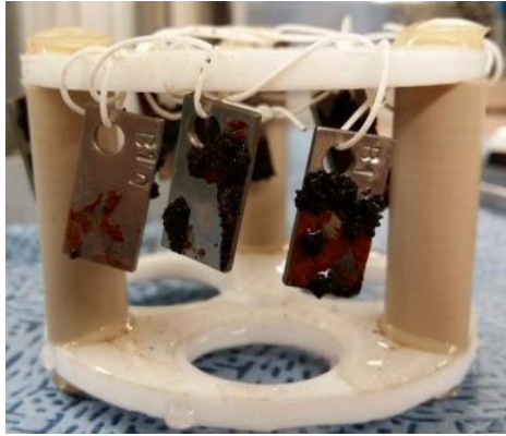
Figure 86 – Observations des éprouvettes en acier API 5L X65 en solution 15 aéré à 90°C après 3 jours d'immersion [94]
