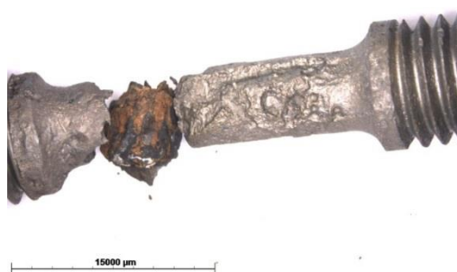
Figure 126 - Macrographie de l'éprouvette PF3 en acier P285NH
