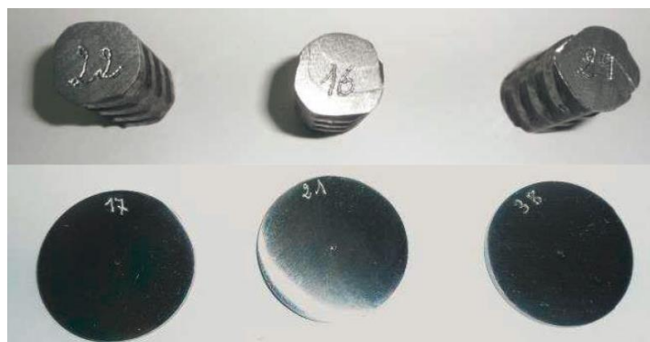
Figure 87 – Echantillon de fer à béton (en haut) et en acier API 5L X65 (en bas) avant immersion dans le béton
