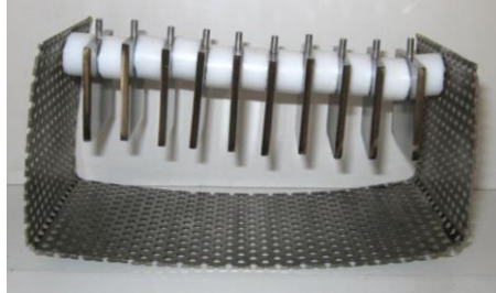
Figure 18 – Coupons destinés aux mesures gravimétriques avant essai
