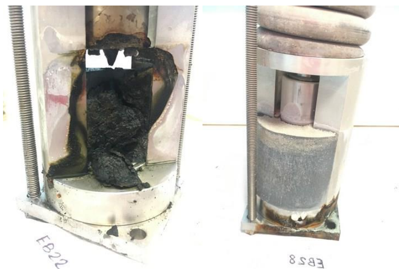
Figure 128 – Enrobage désagrégé en fin d'essai (à gauche) et sain (à droite)
