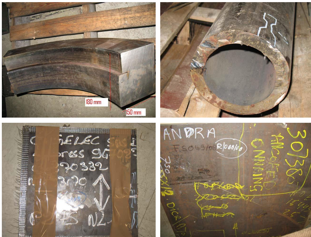
Figure 13 - Aciers ferrito-perlitiques avec structure en bande (de haut en bas et de gauche à droite : P265, API5L grade B, P275NL1, SA516)
