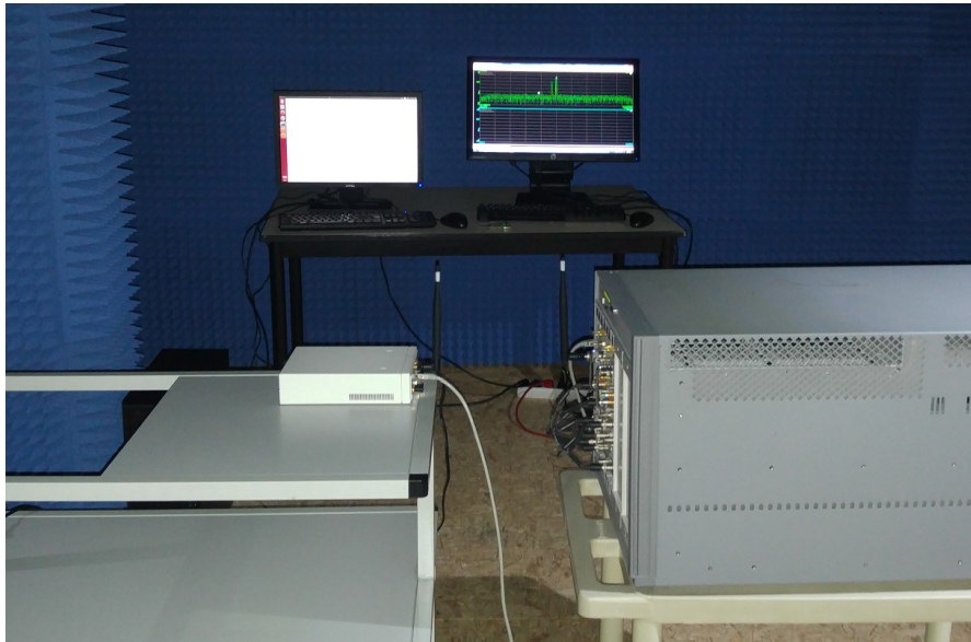
FIGURE 5.10 – Mise en place de l'expérimentation visant à étudier la robustesse en dynamique de l'architecture à deux antennes. Un ordinateur (à gauche) génère les signaux avec GNU Radio et les transmet à l'USRP qui les émet. Ces signaux sont reçus par VSA (à droite) et sont enregistrés dans l'autre ordinateur.
